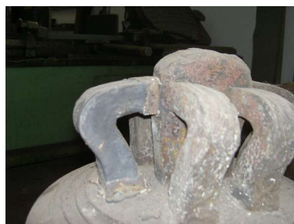
Engelsglocke mit geschweißtem Glockenarm
